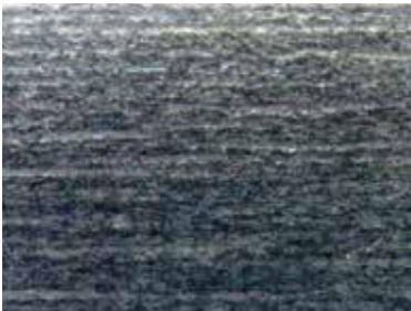
Nitinol-Rohre Innenoberfläche oxidisch
