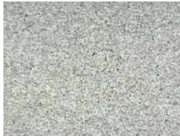
Nitinol-Rohre Innenoberfläche Slurry Cleaning
